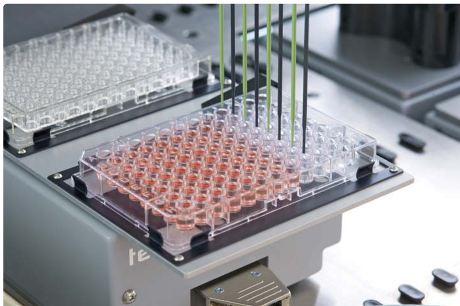
Remplissage automatique d'une plaque microtitre de 96 échantillons avec un milieu de culture cellulaire au moyen du système Freedom EVO®, muni d'un bras à huit canaux et de pointes fixées pour le transport de liquides. (Photo publiée avec l'autorisation de la société Tecan Trading AG)
